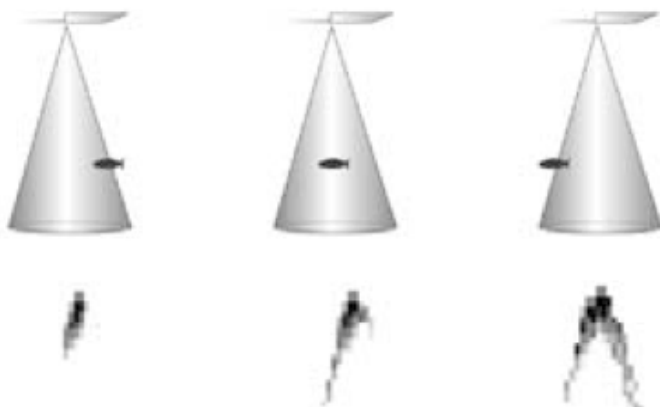
Лучи датчика излучателя и «арки» рыб
